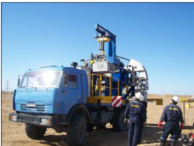
Применение системы hydrolift после обработки скважин методом hydropuls
