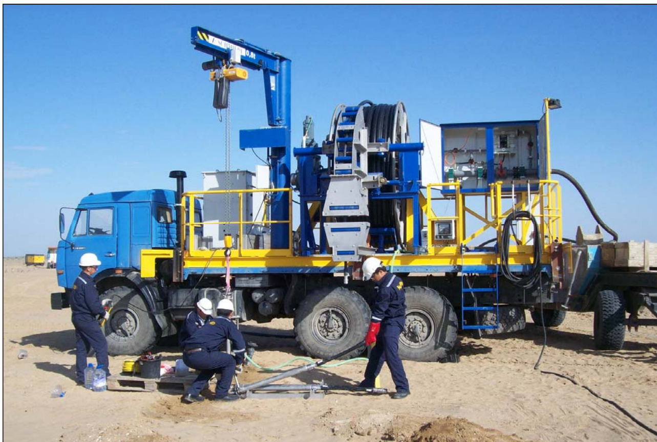
Применение системы hydrolift после обработки скважин методом hydropuls
