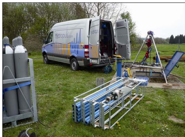
Интенсификация скважины методом hydropuls ®
