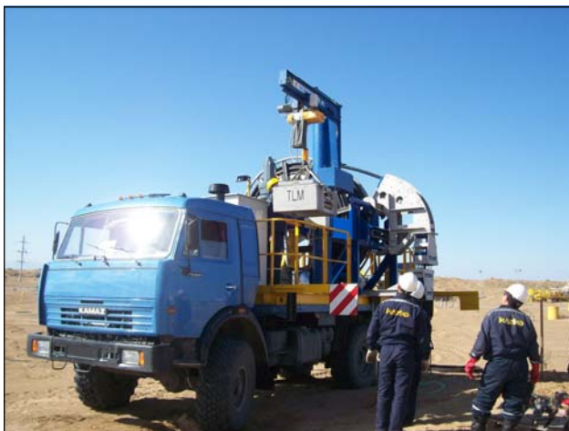
Foto: hydrolift Einsatz in Kasachstan parallel bzw. nach dem Einsatz des hydropuls ® - Verfahrens. Spezialentwicklung der TLM hydropuls GmbH für JV Katco (Areva-Kazatomprom)
