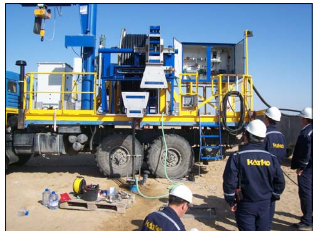
Foto: hydrolift Einsatz in Kasachstan parallel bzw. nach dem Einsatz des hydropuls ® - Verfahrens. Spezialentwicklung der TLM hydropuls GmbH für JV Katco (Areva-Kazatomprom)
